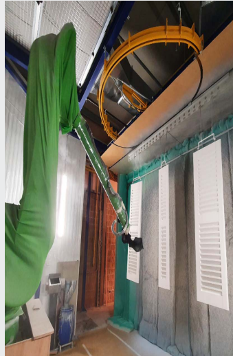
3 COUCHES DE FINITION après un égrenage manuel
